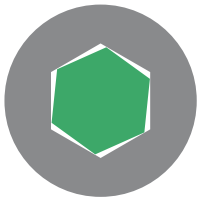
Vista in sezione di come lavorano i driver tradizionali
